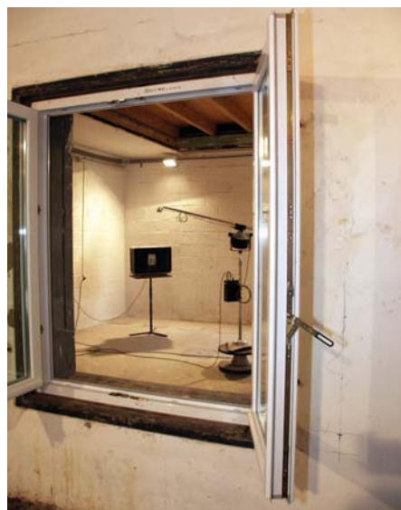
Afb. 1 Er bestaan nu opengaande ramen met een geluidsverzwakkingsindex van om en bij de 45 dB.
